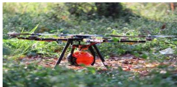
شکل ۳: طراحی اولیه پهپاد آتش‌نشان با حمل توپ اطفای حریق
